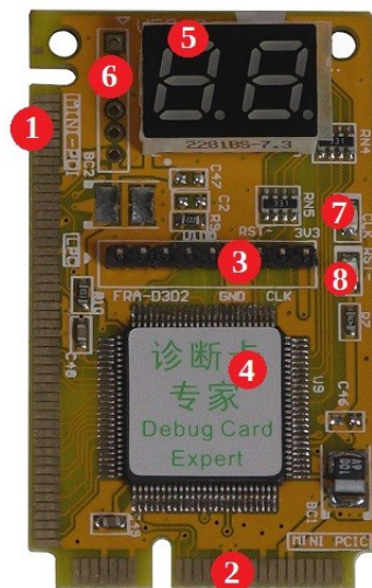
Рисунок 1 — внешний вид отладочной платы с указанием её основных компонентов.
